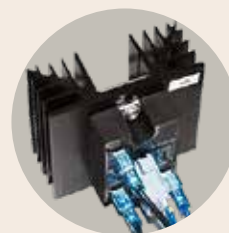
Chauffage à commutation silencieuse par relais semi-conducteurs
