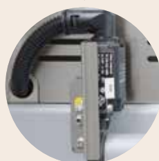
Coupure sécurisée du chauffage à l'ouverture de la cloche
